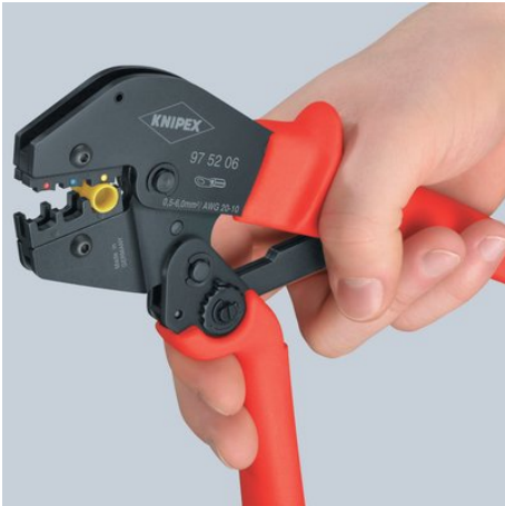
Eerste stap: knijp de benen met twee vingers samen, tot de twee bekken de te krimpen verbinder raken
