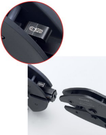
Väl synlig markering av pressbackarna med piktogram
