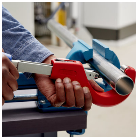
Pro řezání trubek z mědi, mosazi a nerezové oceli o průměru 6 - 35 mm (1/4" - 1 3/8") a síle stěny až 2 mm
