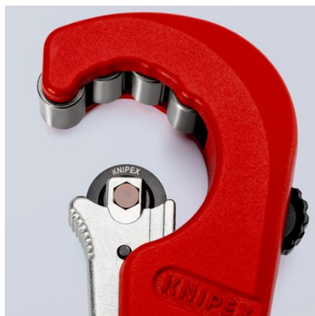
Řezné kolečko s jehlovými ložisky a odpružením je z vysoce kvalitní oceli pro kuličková ložiska a snadno se vyměňuje
