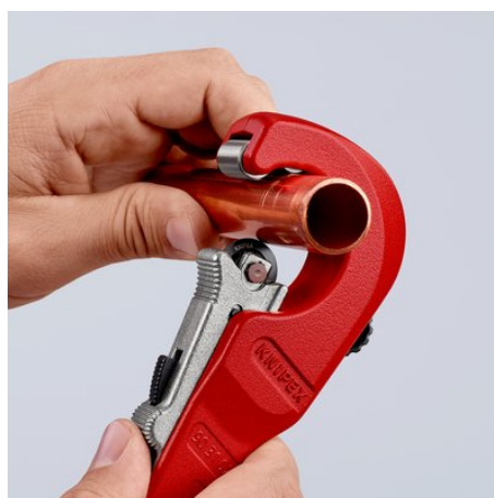
Odpružené řezné kolečko je možné jednou rukou snadno posunout a upevnit v poloze pro konkrétní průměr trubky. Posunutí řezného kolečka proti řezané trubce pomocí rychlého jednoručního nastavení QuickLock: nejrychlejší nastavení na různé průměry trubek
