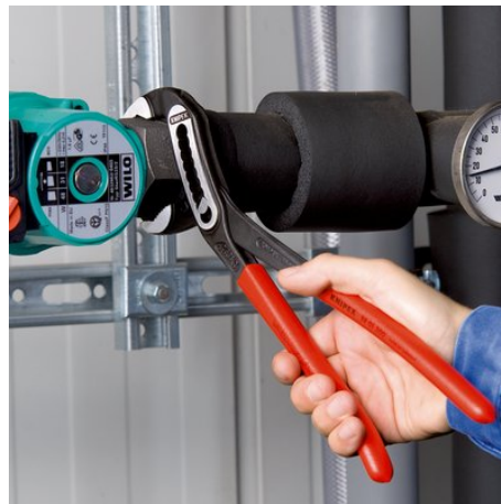
Självlåsandande på rör och muttrar; fast grepp på arbetsstycket, hela manöverkraften kan användas för att vrida arbetsstyckena: fast ihoptryckning av tångskänklarna är inte nödvändigt, därigenom mindre kraftansträngning
