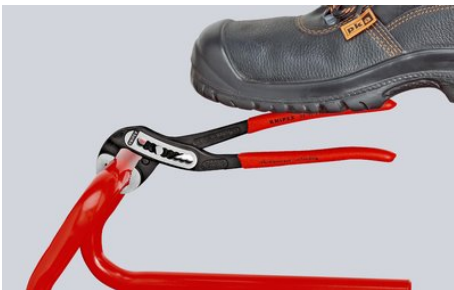
Sjävlåsande på rör och muttrar; fast grepp på arbetsstycket, hela manöverkraften kan användas för att vrida arbetsstyckena: fast ihoptryckning av tångskänklarna är inte nödvändigt, därigenom mindre kraftansträngning
