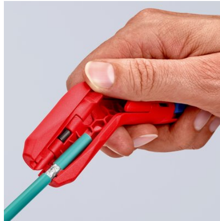
Ontmantelen van een datakabel
