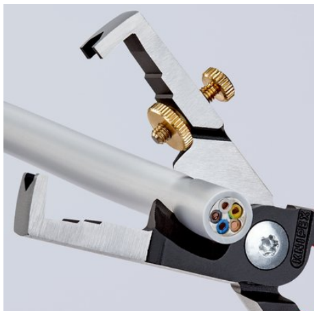
Indukčně kalený stříhací břit s přesným brusem pro řezání měděných a hliníkových kabelů bez přiskřípnutí do Ø 15 Pojistka s kontramací proti náhodnému přestavění mm (5 × 2,5 mm 2 )
