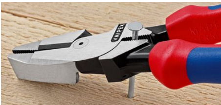
Upínací zóna leží pod kloubem za účelem silného páčícího účinku
