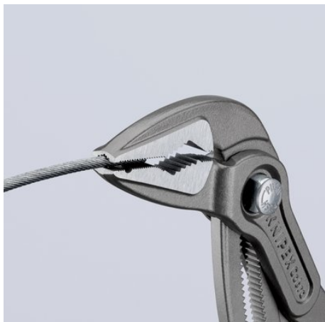
Mâchoires longues et étroites avec denture de préhension frontale : profil de préhension longitudinal pour pièces rondes telles que vis et boulons
